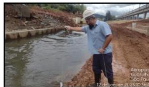
Foto 1 - Procedimento de monitoramento e medição de campo do parâmetro Turbidez - Ponto 01.
